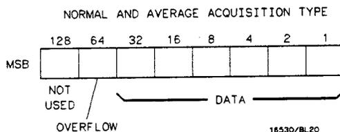
*Figure 10-1. Byte Data Structure*
